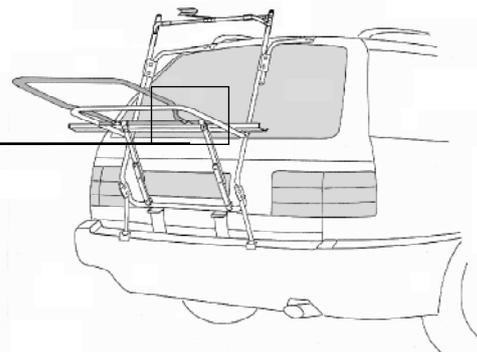
3. Die zweite Alu-Schiene wird im abgeknickten Bereich auf der Auflagenverlängerung montiert Abb. 3.1. Die Gewindeschellen (12) der Alu-Schiene (2) müssen hierzu schräg befestigt werden Abb. 3.2. Die Gewindeschellen (12) müssen mit Unterleggummis (17) versehen werden. Anzugsdrehmoment 10 Nm.
