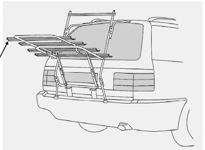
Mit dem Verbindungshalter (2) werden die Rahmen vom 3. zum 4. Fahrrad verbunden. Achten Sie darauf, daß der Verbindungshalter so hoch wie möglich an den Fahrradrahmen befestigt wird.
