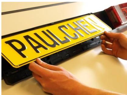
3. Setzen Sie das Kennzeichen zuerst mit der oberen Kante in die Blende ein.
